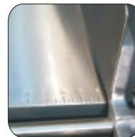
Regulador de espesor de corte graduado que permite ajustar fácilmente el grosor de los cortes, ayudando a tener productos más consistentes.
